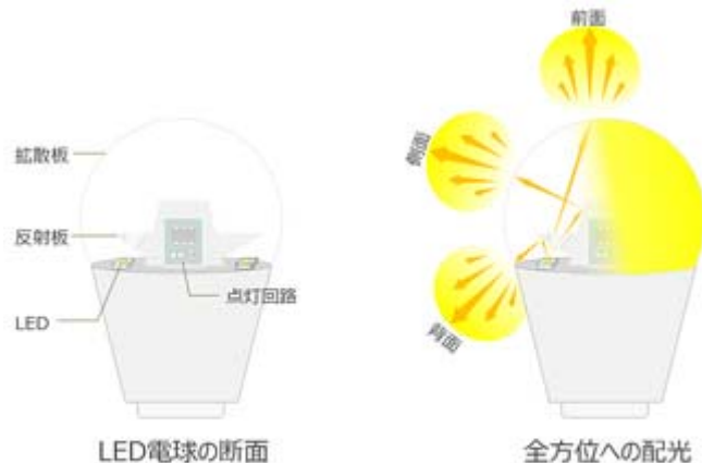
LED電球の構造と配光制御（一例）
